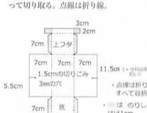
②アルミワイヤー: 直径3mm(ダイヤーで21mmで丸っている)を14cmに切る
