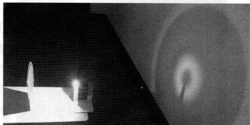
図9 左からCD、光源、壁に映った虹の順に並んでいる。CDと光源の周りに覆いを付けると入射光とゼロ次反射光が見えなくなり虹がきれいに見えるようになる。
